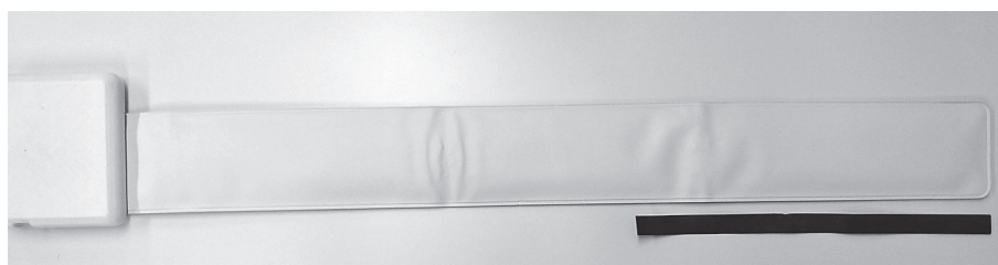
図4 睡眠モニターの外観。マットレスの下に敷いて使用 (黒いテープはサイズ比較用: 30cm)。
