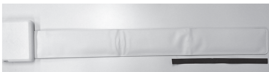
図4 睡眠モニターの外観。マットレスの下に敷いて使用 (黒いテープはサイズ比較用：30cm)。
