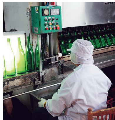
洗びん機で洗浄したびんは洗い残しやキズがないか「人間の目」で細かくチェック
